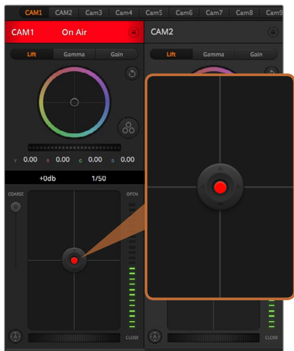
Вкладка для управления диафрагмой/уровнем черного загорается красным, когда сигнал соответствующей камеры выводится в эфир
