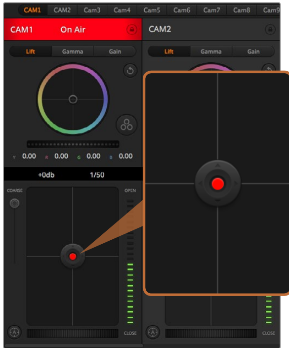
Das Blenden-/Schwarzwert-Bedienelement leuchtet rot auf, wenn die jeweilige Kamera On Air ist
