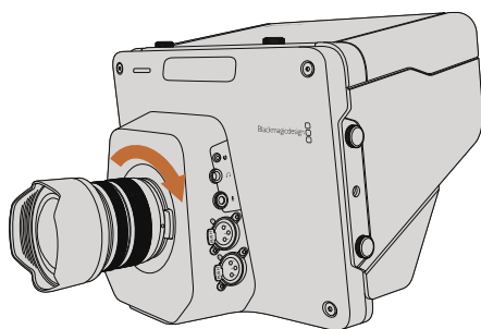
Monter et retirer un objectif sur la Studio Camera
