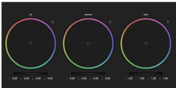
Цветовые круги для работы с параметрами тени, полутона и света на панели цветокоррекции
