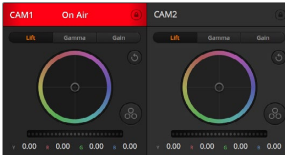
각 카메라 제어 장치에는 카메라가 On Air 상태 인지를 보여주는 채널 상태 표시가 있습니다. 컬러휠을 사용하여 각 YRGB 채널의 리프트, 감마, 게인 설정을 조절합니다.
